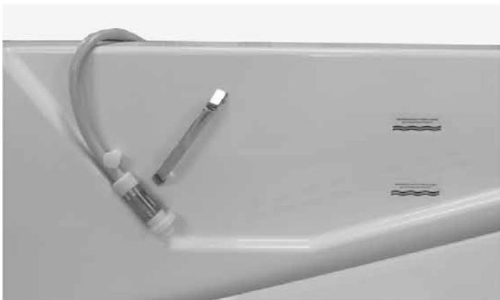
б) Фиксация форсунки ПДМ
